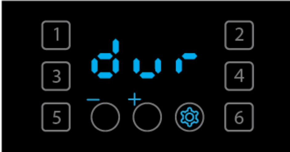
Figur 9, indstilling af varigheden af buzzerlyd.
